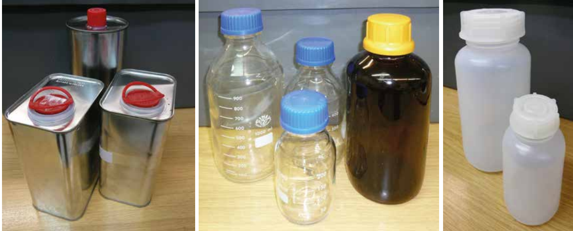
Figure 4: Récipients appropriés pour contenir des échantillons du FAME (Source: ELR Entwicklungslabor Dr Radig)
