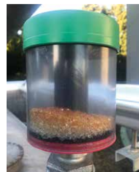
Figure 3: Exemple d'un filtre de déshumidification (Source: Swissfuel AG)
